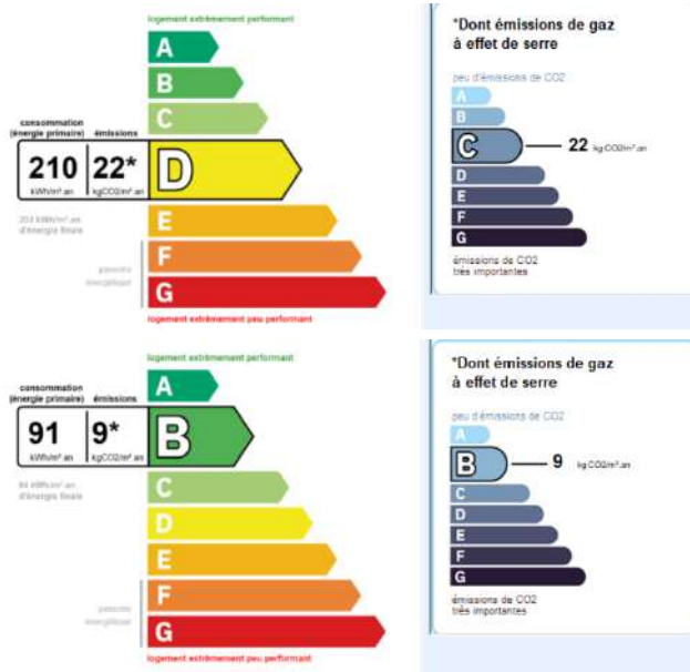
ETIQUETTE ENERGETIQUE SUIVANT METHODE 3CL DPE : LA CONSOMMATION ENERGETIQUE DU BATIMENT PASSE DE LA CLASSE "D" A LA CLASSE "B"
